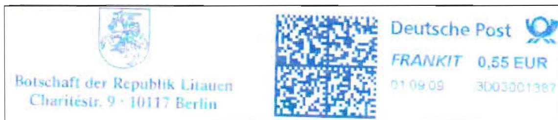
Der Absenderfreistempel (AFS) enthält auf der linken Seite den Werbetext. In der Mitte des Stempels befindet sich eine 2-D Matrix. Diese 2-D Matrix enthält u.a. Angaben über die Stempelmaschine, wie Hersteller und Seriennummer. Zusätzlich sind auch Entgelt und Versendungsart gespeichert.
