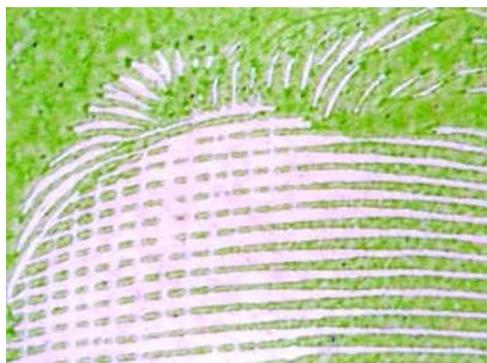
*Bild 38 Feld 89/2 Langstreckiger senkrechter Defekt im rechten oberen Stirnbereich*
