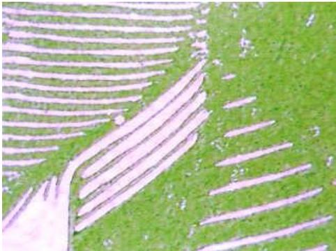
Bild 42 Feld 90/1 Weißer Punkt in der Trennlinie zwischen der Gesichtsschraffierung und dem Bereich der Hemdkragenstriche
