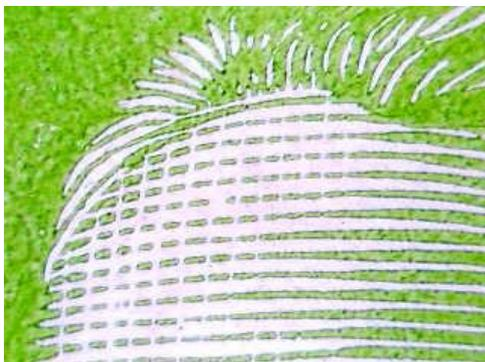
Bild 40 *Feld 50 Stirnstrichdefekt in der 4. durchgehenden Stirnlinie*
